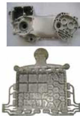
شکل ۱۰-۸- چند نمونه از قطعات ریخته‌گری شده به روش دایکاست پیوسته
