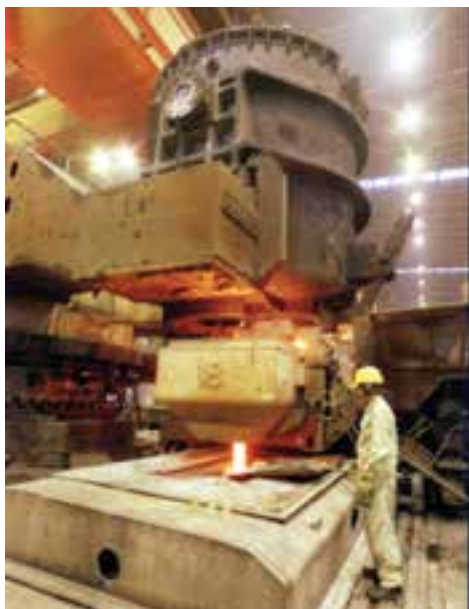
شکل ۱۴-۸- عملیات ذوب‌ریزی از پاتیل حمل مذاب
