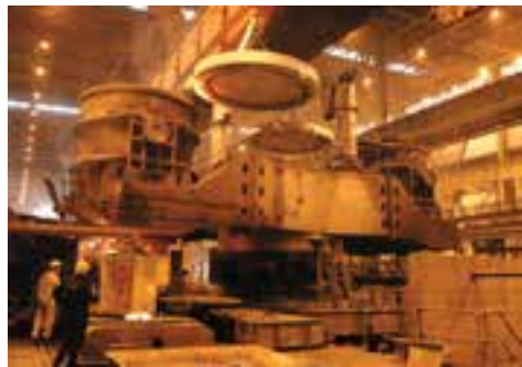
شکل ۸-۱۱- تخلیه مذاب یا مذاب‌ریزی از درون پاتیل حمل مذاب در ابتدای خط ریخته‌گری پیوسته.
